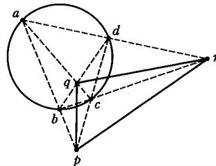
(1), (1)' は、残りの2つの交点 Q と R を結ぶ直線がはじめの交点 P を極とする極線になっていることを示している。
