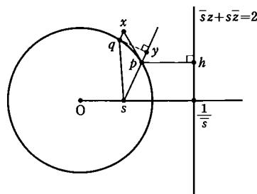
一方、中心力のみが働いているとき面積速度 $V_s$ 一定の法則が成り立つので、惑星の動径SPが描く扇形に似た図形SPQの面積（極限では $\triangle SPQ$ の面積）は、所要時間 $\Delta t$ に比例する。点Qから直線SPに下ろした垂線の足をYとするとき、
