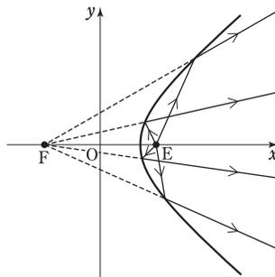
図2 双曲線の中での光の反射
