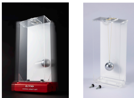
図2 スマートカートと台車上の振り子実験器
