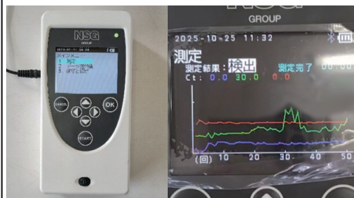
図 モバイルリアルタイム PCR 装置(PicoGene®PCR1100) (左:装置外観, 右:測定結果)
