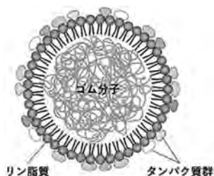
図1 ラテックス中のゴムのコロイド粒子(模式図)
