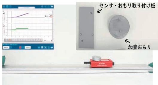
図 1 加重おもり(1個 250g)を2個搭載したスマートカートの運動 \*スマートカート本体は約 250g
