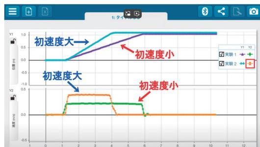
図10 上段は  $x-t$  グラフ 下段は  $v-t$  グラフ
