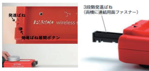
図8 スマートカートを3段階の力で発進させるばね
