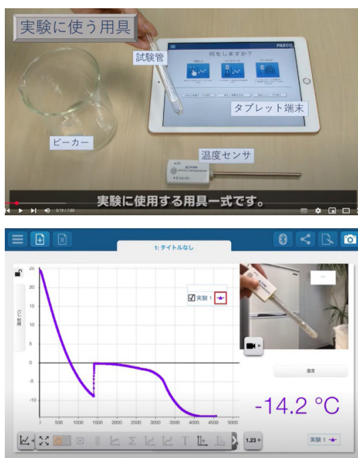
図8 水の過冷却現象を温度センサで確認したグラフ 1)
