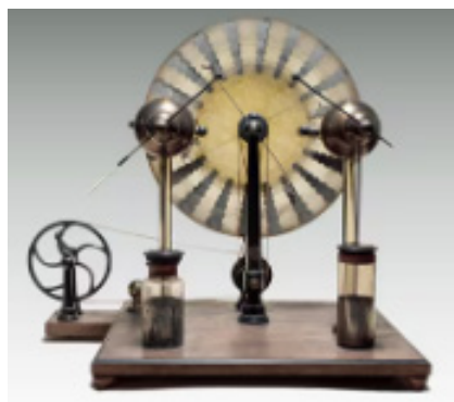
図2 ウィムシャースト感応起電機 1884年(明治17年)二代目源蔵が完成させたもの。 "島津の電気"とよばれ、以降100年以上が過ぎた今でも実験器械として利用される。
