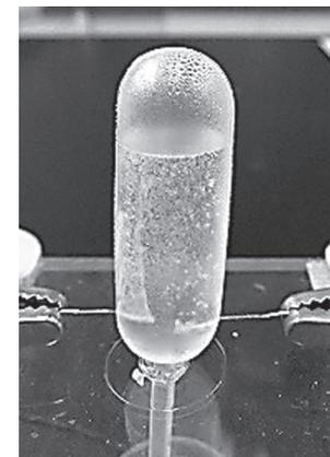
図2 硫酸ナトリウム水溶液の電気分解
