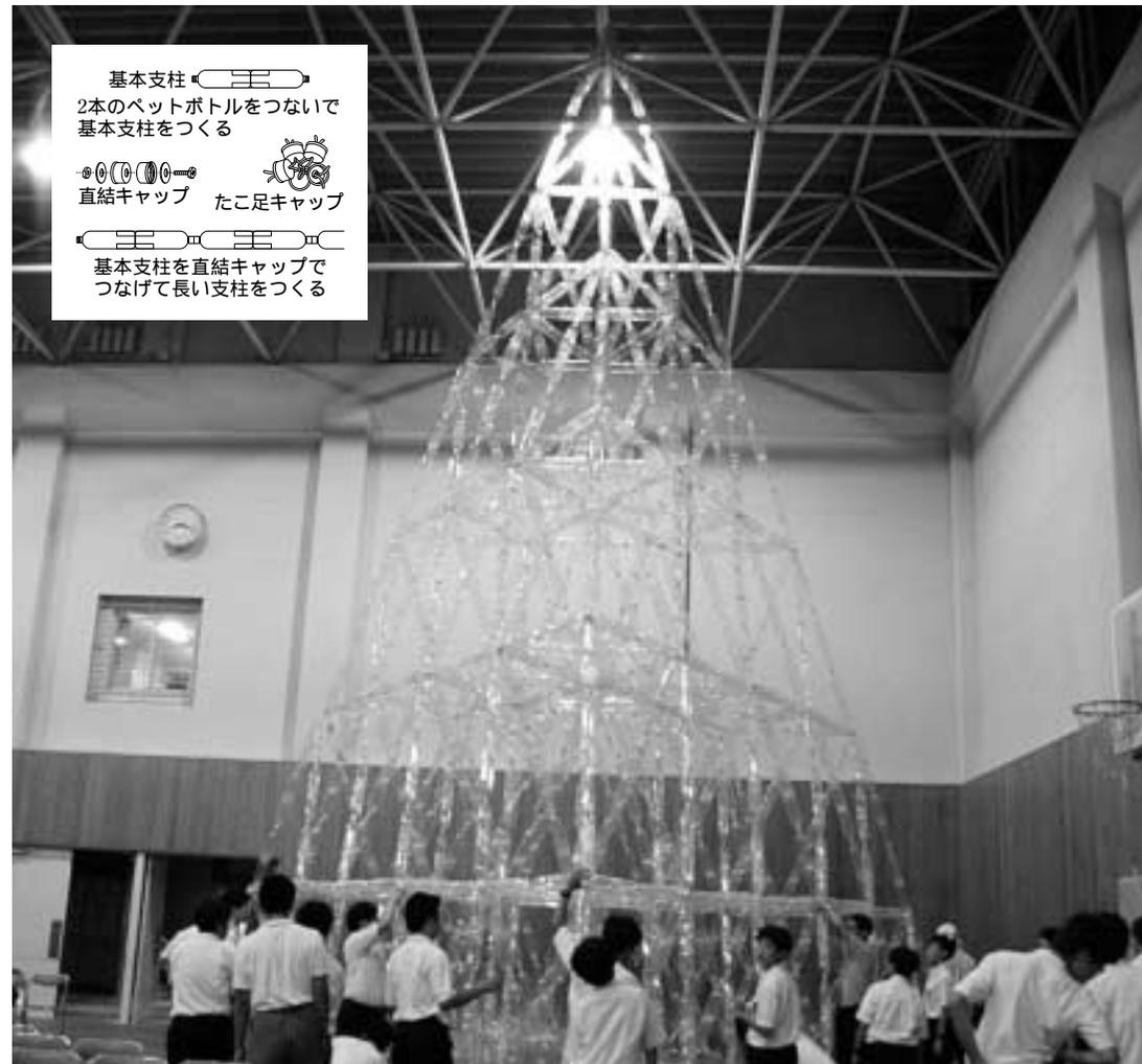
ペットボトル・トラス競技...ペットボトルの軽くて丈夫な特性をいかして、巨大な立体を組み立てるという競技です。2本のボトルからなる「基本支柱」を「直結キャップ」で連結し、さらに「たこ足キャップ」に接続して立体を組み立てていきます。「たこ足キャップ」はグラグラですが、三角形を組み合わせることによって、つぶれない立体をつくることができます。(写真提供: 摂陵中学校・高等学校教諭 塚平恒雄)
