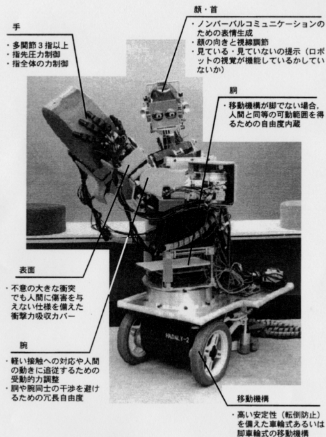
図3 人間共存型ロボットの機能 (Hadaly-2) (早稲田大学ヒューマノイド研究所)
