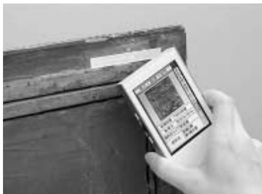
図6：美術品にUコードを取り付け、美術品の管理情報を閲覧している「ウェル.com」プロジェクト, 国立西洋美術館, YRPユビキタスネットワークング研究所, 平成18年5月)
