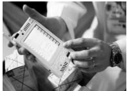
図4：医薬品の安全性情報システム(YRPユビキタスネットワークング研究所，東京大学医学部附属病院，平成16年度) 医師が携帯型端末をもち，医薬品に取り付けられたUコードを読み取ると，どういふ薬かがわかる。これによって，処方箋の処方内容とあっているかチェックし，投与ミスを防ぐことができる。また，医薬品の生産，流通のトレーサビリティ情報も得られるため，偽造薬(日本国内ではみられない)がや使用期限が過ぎた薬を発見することもできる。
