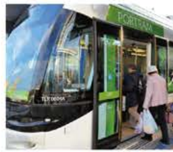
▲図4 富山市に導入されたLRT(次世代型路面電車) 車内・車外で段差がなく、車いすの人でも介助なしで利用できる。
