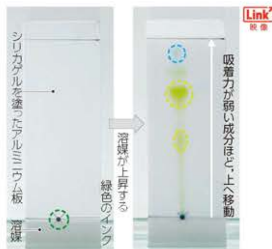
●図12 薄層クロマトグラフィー 微量の試料でも実験することができ、ペーパークロマトグラフィーよりも短時間で進行することができる。
