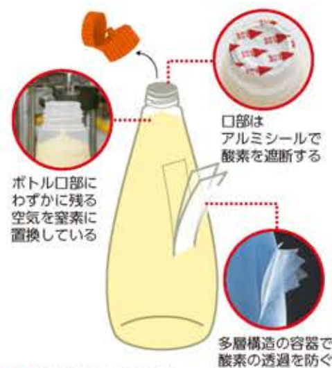
図17 マヨネーズの容器 複数の技術を用いて、マヨネーズの酸化を防いでいる。
