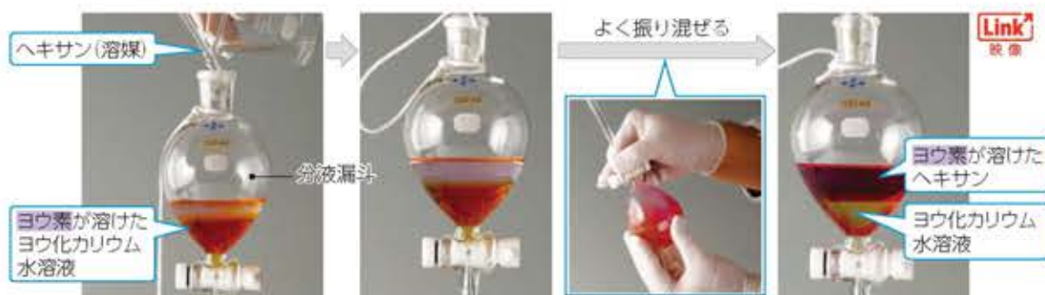
●図10 抽出 ヨウ素は水よりもヘキサンなどの有機溶媒(有機化合物の溶媒)に溶けやすい。そこで、ヨウ素ヨウ化カリウム水溶液(ヨウ素をヨウ化カリウム水溶液に溶かしたものに、ヘキサンを加えてよく振る。その後静置すると、ヘキサンと水溶液は二層に分かれる。このとき、ヨウ素はヘキサン(上層)に移り分離することができる。
