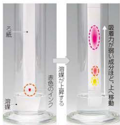
●図11 ペーパークロマトグラフィー いくつかの色素が混ぜられたインクをろ紙につけて乾燥させ、ろ紙の一端を適当な溶媒に浸すと、インクに含まれる成分を分離することができる。
