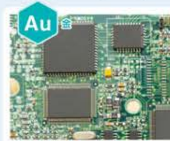
図E 集積回路 金は、電気伝導性や耐腐食性に優れていて、コンピュータの回路に使われる。
