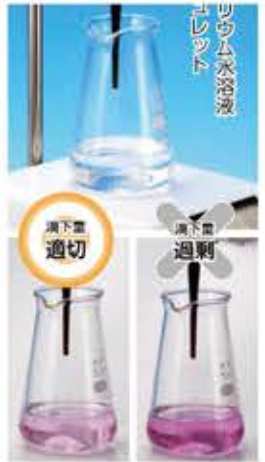
図7 過マンガン酸カリウムを用いた酸化還元滴定 過マンガン酸カリウムは光によって分解しやすいので、褐色ビュレットを用いる。振り混ぜても赤紫色が消えなくなったところが終点。
