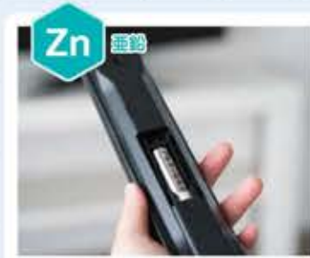
図F 電池 亜鉛は、マンガン乾電池やアルカリマンガン乾電池などの負極に使われる。
