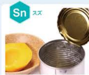
図G 缶詰容器 鉄板表面をスズでおおったもの(ブリキ)は、缶詰容器に使われる。
