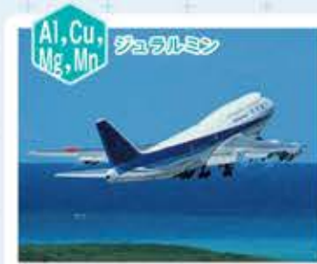
図L 航空機 ジュラルミンは、軽くて強度が大きいので、航空機の機体利用されている。
