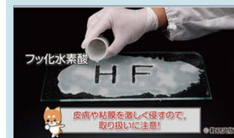
フッ化水素によるガラスの腐食
