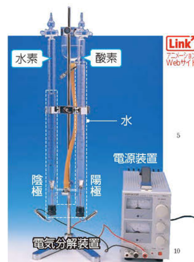
図14 水の電気分解 電気を通しやすくするため、水酸化ナトリウムを少し加える。
