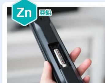
図F 電池 (p.164) 亜鉛は、マンガン乾電池やアルカリマンガン乾電池などの負極に使われる。
