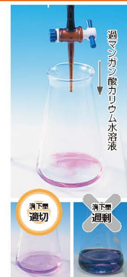
図7 過マンガン酸カリウムを用いた酸化還元滴定 過マンガン酸カリウムは光によって分解しやすいので、褐色ビュレットを用いる。振り混ぜても赤紫色が消えなくなったところが終点。
