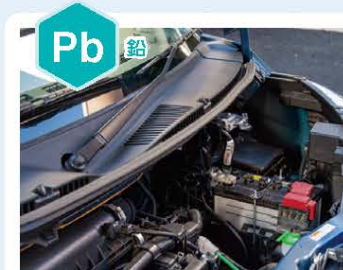
図H 鉛蓄電池 (p.166) 鉛は、自動車のバッテリーの負極に用いられている。
