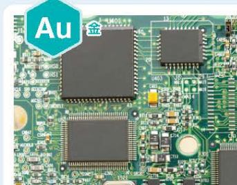
図E 集積回路 金は、電気伝導性や耐腐食性に優れていて、コンピュータの回路に使われる。
