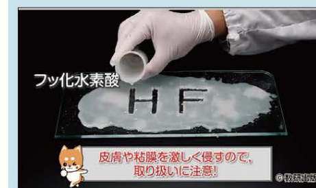
フッ化水素によるガラスの腐食
