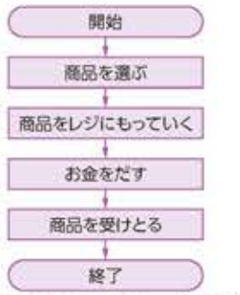
図4 フローチャートの例(商品の購入) 図形と図形を線でつなぐ。流れを明示する場合は矢印を使う。
