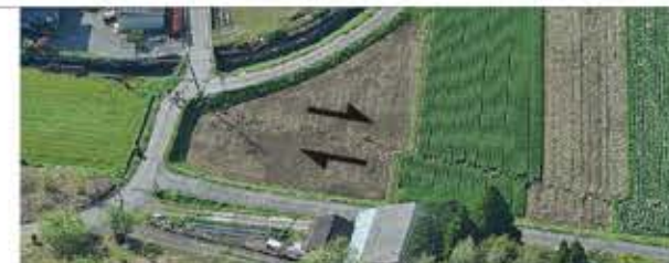
図31 地震断層 2016年熊本地震により地表に現れた右横ずれ断層。矢印の向きに断層が動いた。
