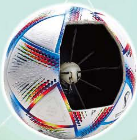
△図4 近年のサッカーボール 2022年のワールドカップカタール大会での試合球。表面に熱接合が施されている。ボールの中心に内蔵したセンサーで衝撃を感知し、選手がけた地点や時間を計測する。
