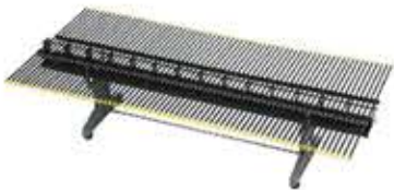
図12 ウェーブマシン 等間隔に並べた鉄棒の中央を薄い鉄片でつないだもの。鉄棒の一端を上下に振ると、鉄棒をつなぐ鉄片のねじれによって変位が徐々に伝わる。図13と図14では、この装置を用いている。
