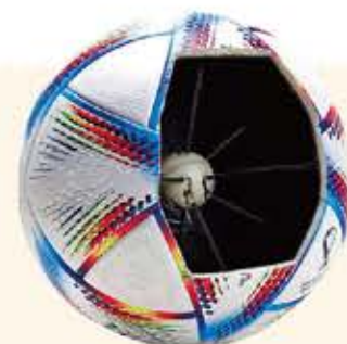
図3 近年のサッカーボール 2022年のワールドカップカタール大会での試合球。表面に熱接合が施されている。ボールの中心に内蔵したセンサーで衝撃を感じ、選手がけた地点や時間を計測する。
