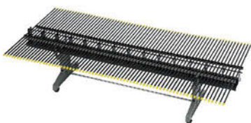
▲図12 ウェーブマシン 等間隔に並べた鉄棒の中央を薄い鉄片でつないだもの。鉄棒の一端を上下に振ると、鉄棒をつなぐ鉄片のねじれによって変位が徐々に伝わる。図13と図14では、この装置を用いている。
