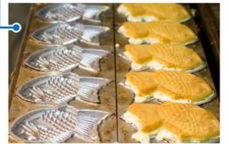
図9 たい焼きの鑄型 たい焼きは、専用の鑄型から写し取られて(転写されて)つくられる。
