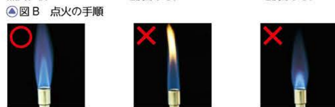
▲図C ガスバーナーの炎の調節
