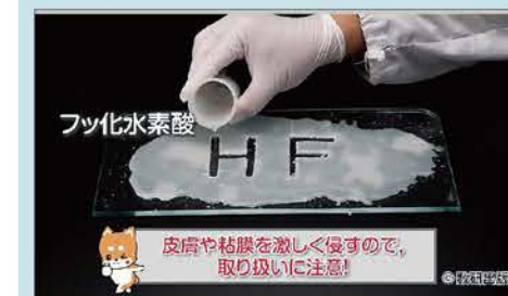
◀ フッ化水素によるガラスの腐食
