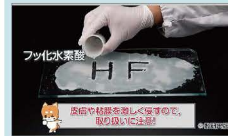
◀ フッ化水素によるガラスの腐食
