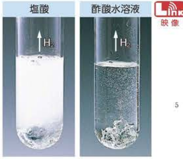
▲図5 塩酸・酢酸水溶液と亜鉛の反応
