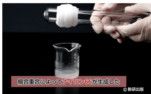
図14 「ナイロン66を合成しよう」の実験映像 手間がかかる実験でも、結果まで含めた一連の流れを手軽に確認できます。
