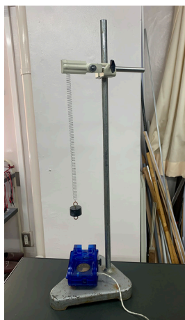
図 2 鉛直ばね振り子の実験 (左上) 実験装置 (右上) ばねの振動を表すグラフの分析と、それを文章で『表現』する課題 (右下) ばねの振動を表すグラフの数値的な分析をする課題
