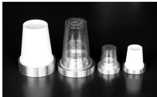
図 4 7 オンスと 1 オンスのコップに合わせた「シャボン玉爆鳴器」 7 オンスコップ用の「シャボン玉爆鳴気実験セット（ベークライト製）」がケニス株式会社より販売されている 4) 。
