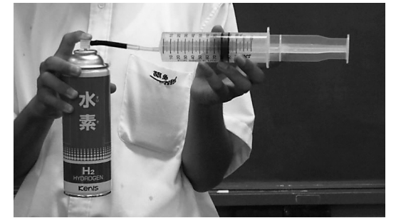
図2 ディスポーザブル注射器を用いた調合 1mL単位の正確さで気体を取ることができる。
