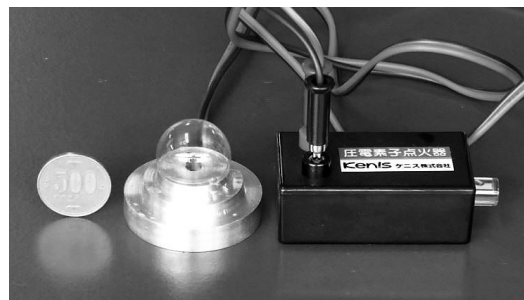
図 5 シャボン玉爆鳴器 気体をシャボン玉に閉じ込め圧電素子で点火する。
