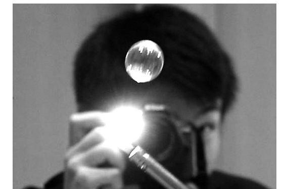
図3 「ブタン8mL+水素40mL+酸素72mL」で混合した爆鳴気の10mLのシャボン玉 浮きも沈みもしないで空中を漂う。
