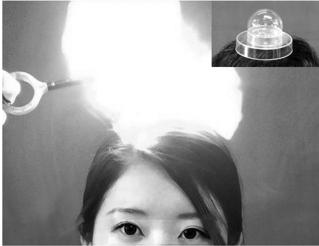
図1 実験「エンゼルリング」 1) 頭の上に、大小2種類のプラスチック製ペトリ皿の底を2段に重ねてのせ、その上に60mLの水素爆鳴気のシャボン玉をつくり、点火・爆発させてみた。大きい爆発音と火の玉ができるが、火傷をすることも髪の毛が燃えることもない。エネルギーは、使い方を間違えると何の仕事もしてくれないことを教えてくれる実験である。60mLの水素爆鳴気のエネルギーは288Jであるが、仕事率は17,280W以上にもなる。
