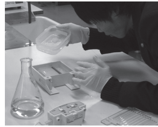
図5 ゲルトレーを泳動装置にセット
