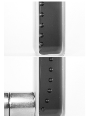
図5 \text{bmim}[\text{FeCl}_4] 中の \text{N}_2 の 気泡が磁石に反発する様子
