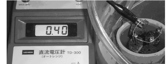
図 18 出力を計測しているようす
