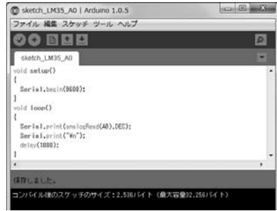
Fig.9 LM35の出力をA0で受け取るスケッチ
