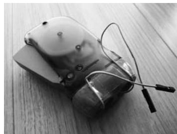
Fig.13 発電機付 LED 懐中電灯を改造する
