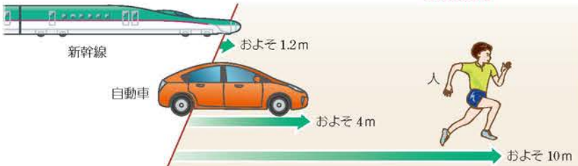
図 11 人・自動車・新幹線の加速のようす スタート直後の 2 秒間に進む距離を表す。
